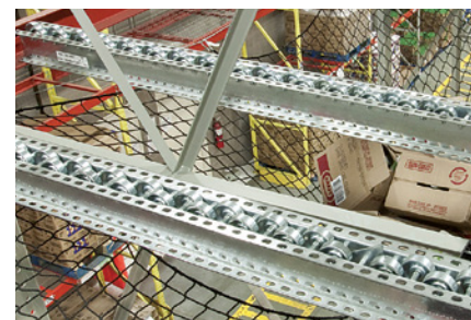
Filets de sécurité horizontaux
